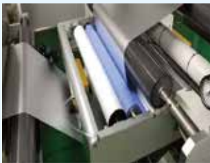
라미네이션 및 실링 공정 이물 제거 장치 (자석Bar, 점착롤, 웹크리너 등)
