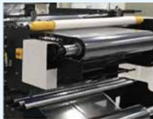
라미네이션 및 실링 공정 이물 제거 장치 (자석Bar, 점착롤, 웹크리너 등)
